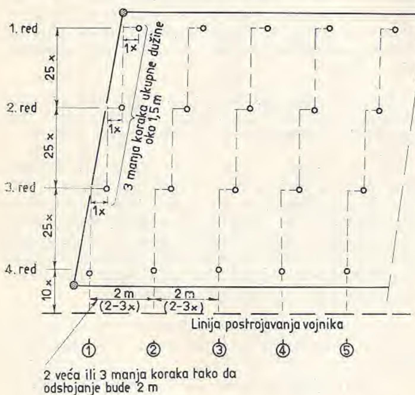
Sl. 24 — Način raspoređivanja protivpešadijskih mina strojevim rasporedom — prvi način
